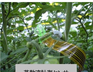
蒸散流計測センサ
