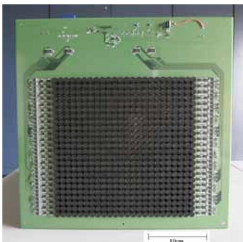
図3: 試作した 576ch パラメトリックスピーカ
