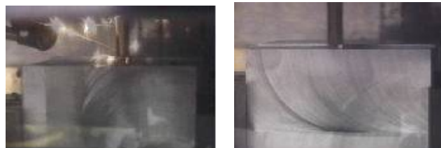
実験中の工具・被削材の状況 大気中では火花が発生するのに対して（左図）窒素ブローでは火花は発生せず（右図）工具寿命が長い
