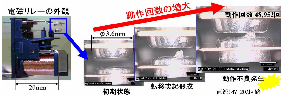
図1 接点材料転移による動作不良の発生例。動作回数の増加に伴い陽極から陰極への転移量が増大し転移突起が形成され、最終的に動作（開離）不良に至った。
