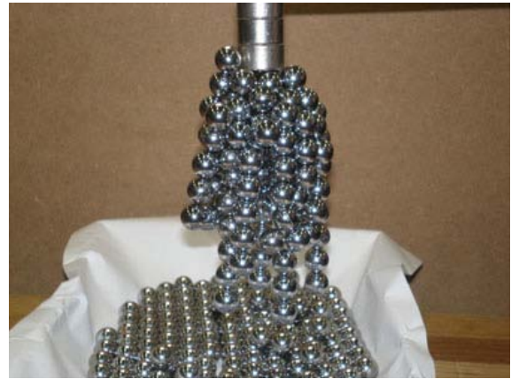
＜Nd-Fe-B 系焼結磁石による鉄球の引き上げの様子＞
